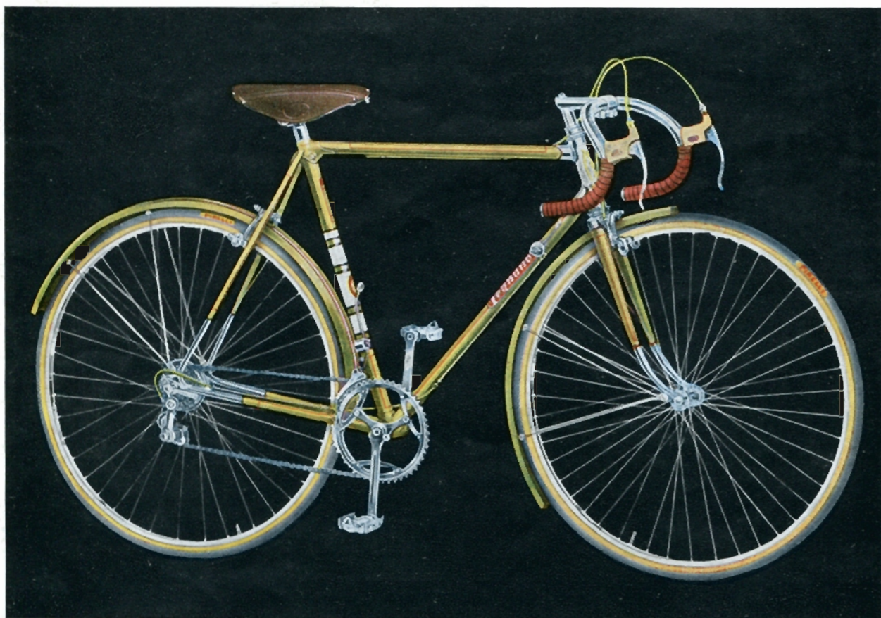
Mod. Roma · Simplex Caratteristiche del modello Roma-Campagnolo 1952 ma: Telaio unica altezza di cm. 57,5 Cambio Simplex "Tour de France" con deragliatore - Morzi con bloccaggio Simplex - Guardarullo a doppio ingranaggio 47 - 50 denti - Ruota libera a 5 corone 15 - 17 - 19 - 21 - 23 - Tubolari Pirelli specialissimi corsa.
