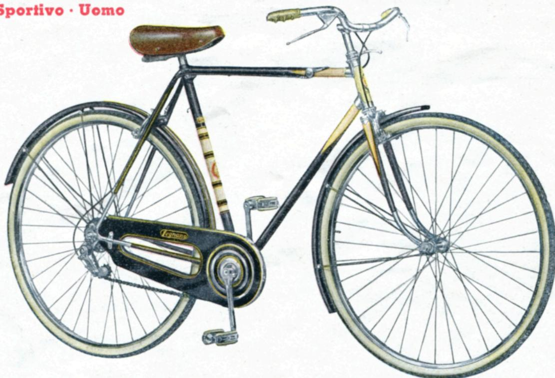
Verniciatura nera - filetti oro - Sterzo e fiamme ai tubi e forcella, tinta avorio - Pipe sterzo, punte foderi e forcellini finemente **cromati** - Manubrio sportivo - Freni alluminio a trasmissione flessibile - Mozzi con dado a scodellino - Cambio di velocità - Parafanghi acciaio costa cromata, anteriore corto - Copricatena con costa cromata - Sella con molle cromate, copertina pelle - Pedali a 6 gomme bianche - Cerchi acciaio sport - Pneumatici Pirelli **bicolore** bianco-neri 28 x 1 5/8",
